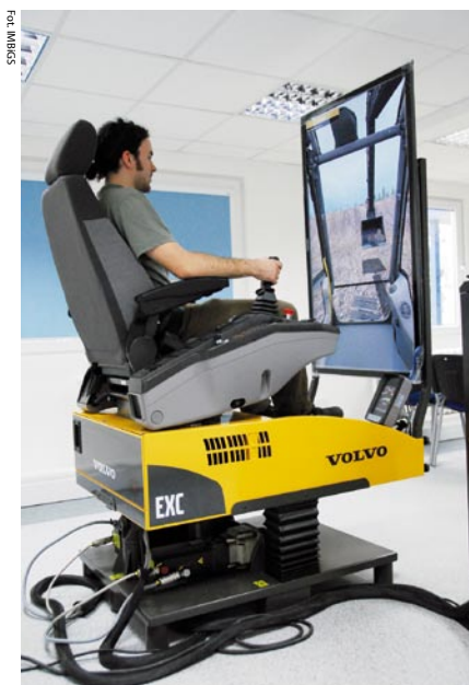
Trójosiowy symulator opracowany i zbudowany z wykorzystaniem podzespołów koparki Volvo EC210C
