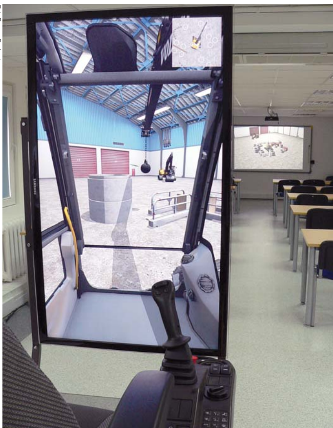
Symulator koparki gąsienicowej Volvo EC210C pozwala na obserwację pracy operatora na tablicy interaktywnej
