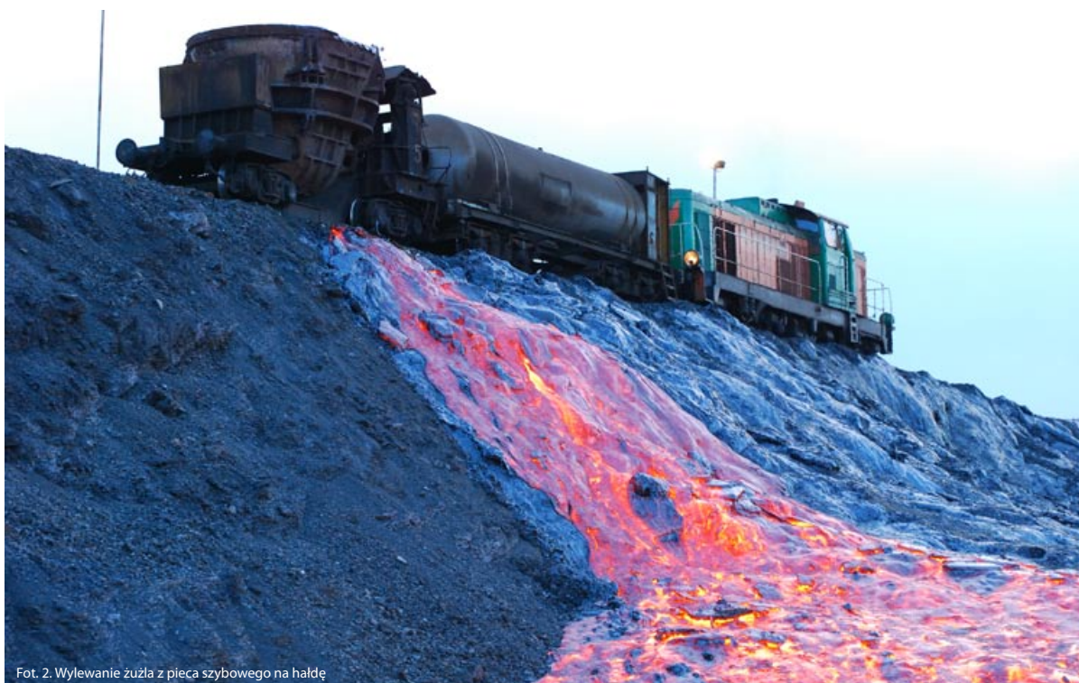
Fot. 2. Wylewanie żużla z pieca szybowego na halde
