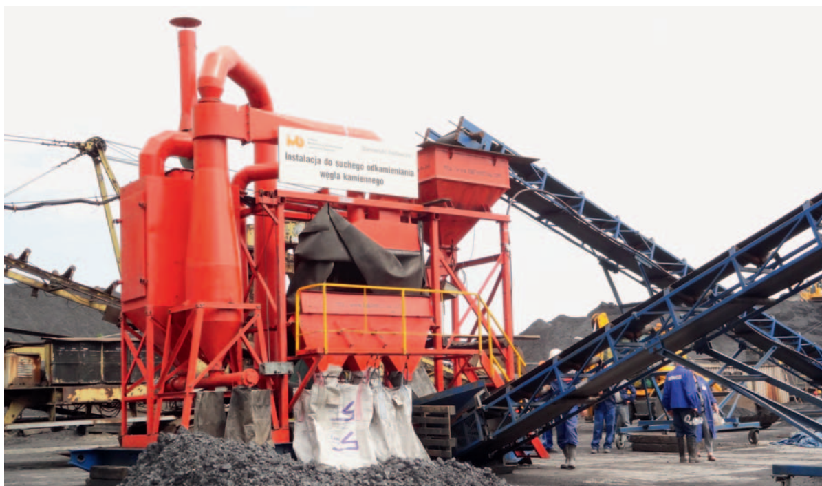
Fot. 1. Instalacja typu FGX-1 do suchego odkamieniania węgla kamiennego
