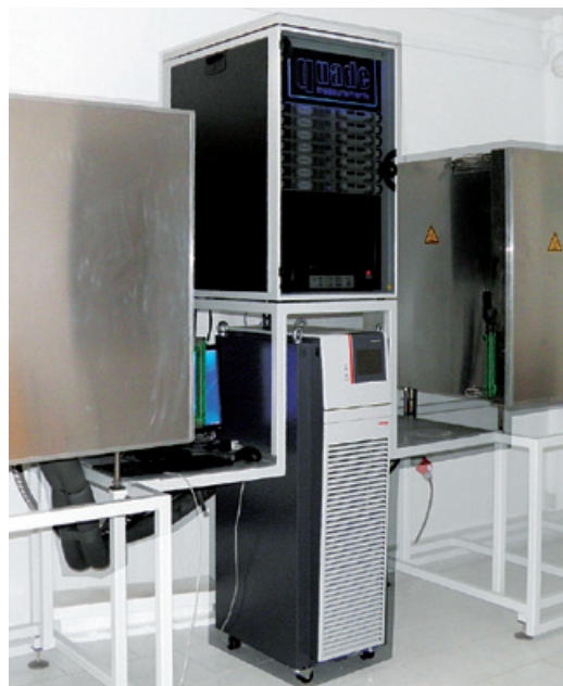
FOT. 2 Urządzenie do badań współczynnika ciepła wyrobów cylindrycznych
