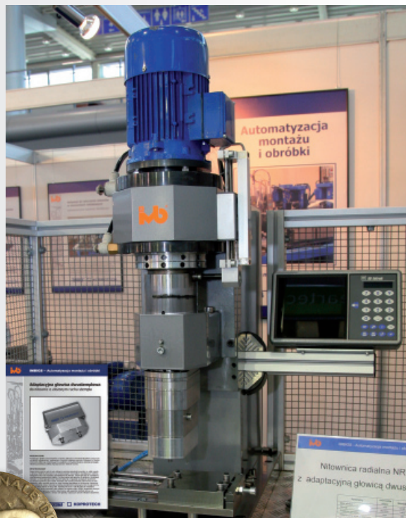
Widok zewnętrzny głowicy dwustemplowej zainstalowanej na nitownicy radialnej NRW-8
