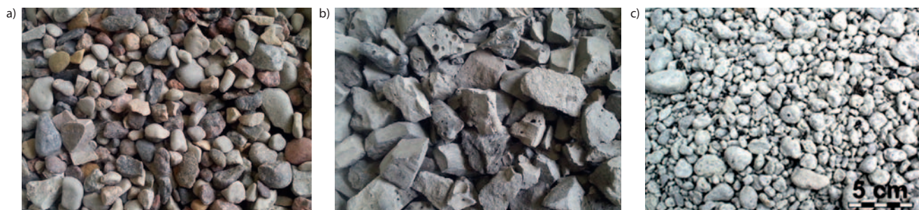
Rys. 2. Przykładowe rodzaje kruszyw: a) kruszywo naturalne, b) kruszywo z żużla, c) kruszywo wg technologii IMBiGS
