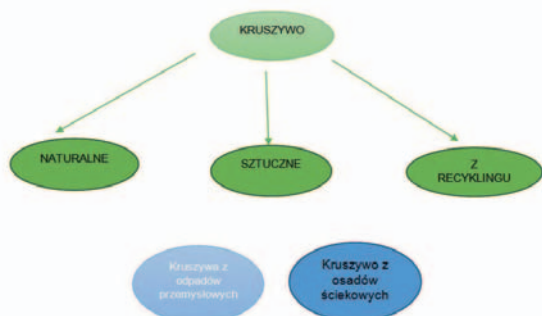
Rys. 1. Podział kruszyw uwzględniający rodzaj surowców, z których są wytwarzane
