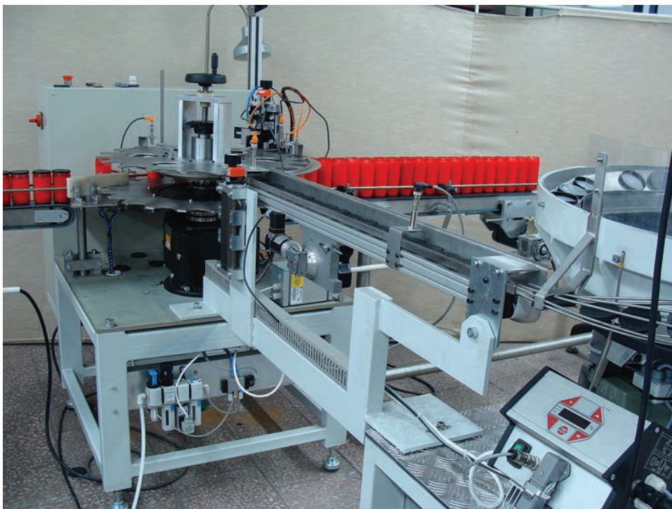
Rys. 2. Urządzenie do napełniania zniczy. Wsporniki, blaty lub stół obrotowy maszyny są elementami o potencjale zastosowania kompozytów
