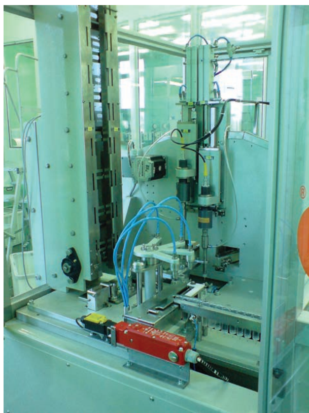
Rys. 3. Urządzenie do montażu pojemników „dozowników medycznych kroplówek” w przyrządach do infuzji. Błaty, ściany grodziwe, kolumnę lub ramie podające ciecze można wykonać wykorzystując kompozyty
